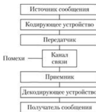
Рис. 2.2. Общая схема приема-передачи информации
