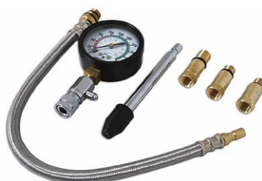
Рис. 5. Компрессометр с насадками-переходниками под разные типы свечей
