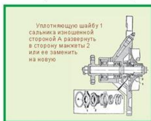
Рис.6- Перестановка изношенной детали
