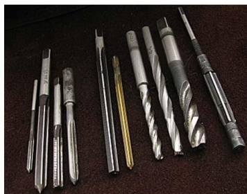
Рис. 1. Развертка – режущий инструмент, который нужен для окончательной обработки отверстий после сверления, зенкерования или растачивания
