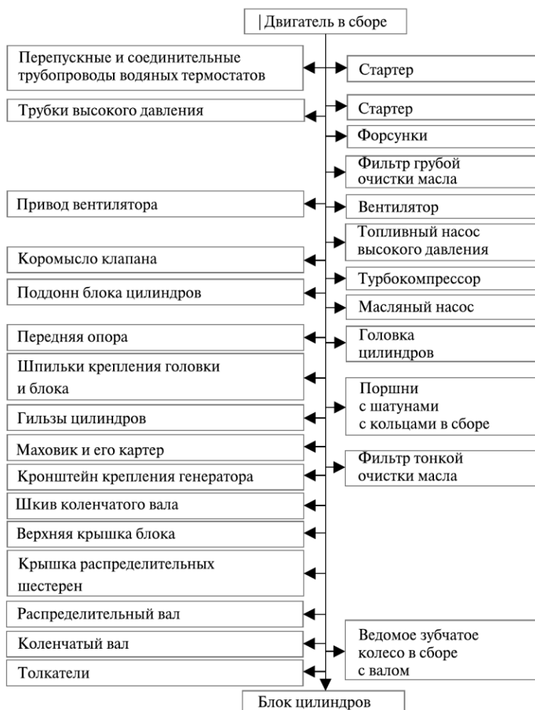
Рис.1. Технологическая схема разборки двигателя
